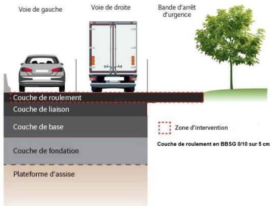
Ces travaux consistent à raboter et décaper la chaussée sur les deux voies de circulation et la bande d'arrêt d'urgence sur une épaisseur de 5 cm. Une nouvelle couche de roulement de 5 cm sera ensuite réalisée sur les deux voies de circulation et la bande d'arrêt d'urgence.
